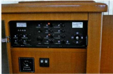
Schaltzentrale für die Komfort-Stromkreise: Einfach zu bedienen, die Intelligenz fürs Energiemanagement sitzt dahinter. Auch hier sind alle Komponenten gut zugänglich
