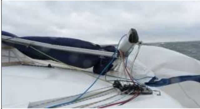
Plötzlich knallte es und der Schreck saß tief: Ganz unerwartet brach im oberen Drittel der Mast, knickte ein und fiel durch die nun fehlende Wantenspannung samt Segel auf die Lee-Seite (Backbord). Das ganze Rigg hing an den noch intakten Wanten, schleifte im Wasser und verursachte bei dem Sturz und den Schiffsbewegungen im
