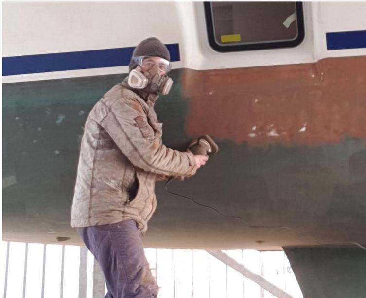
Schleifen, schleifen, schleifen. Eine Sau-Arbeit! und das bei eisigen Temperaturen, zum großen Teil über Kopf, die Arme erlahmen. Und alles mit Schutzmaske und –Brille gegen den giftigen Staub. 3 Tage habe ich für den Stb-Rumpf gebraucht, um das alte Antifouling (Coppercoat) am Unterwasserschiff anzuschleifen. Das ist aber unbedingt notwendig damit, der Renovierungsanstrich hält.
