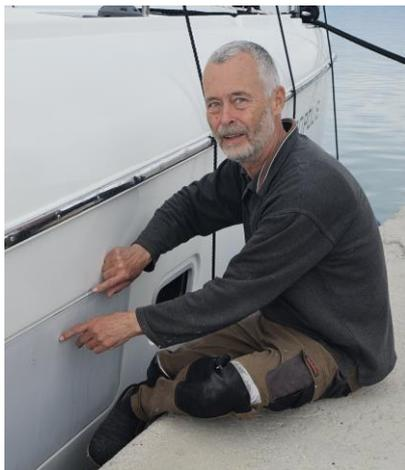
Bei starkem Regen zeigte sich die Undichtigkeit am tb-Rumpf in der Bugkabine. Es war zunächst nicht klar, wo das Wasser reinkommt. Zunächst hatten wir die Scheuerleiste im Verdacht und dichteten alle Verschraubungen ab, aber das war es nicht. Durch Zufall entdeckten wir die Undichtigkeit an der Fuge des großen Kabinenfensters, die wir rausschneiden und erneuern mussten.
