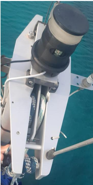
Die 4 Fallrollen und -Wellen im Masttop waren stark verschlissen und mussten ausgetauscht werden. Da die Originalteile von Seldén scheinbar den Belastungen nicht gewachsen sind, hat Christoph die Gleitlagerbuchsen aus Kunststoff gegen selbstschmierende Metallbuchsen ausgetauscht. Die neuen Lagerwellen hat er aus Material mit gehärteter Oberfläche gedreht.
