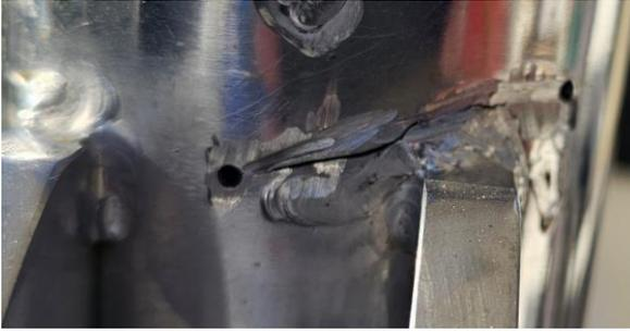
Vor dem Schweißen wurden die Risse angeschliffen und an den Enden gebohrt.
