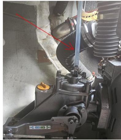
Bei den Saildrives haben wir eine Neuerung eingebaut. Das geschlossene Getriebeölsystem macht bei Temperaturschwankungen ein Problem: Bei Überdruck kann Öl an der Propellerwelle ins Wasser austreten und bei Unterdruck Wasser ins Öl angesaugt werden. Ein offener Schlauch am Getriebe sorgt nun für einen Drückausgleich. Das Öl kann darin nach Belieben aufsteigen und abfallen.
